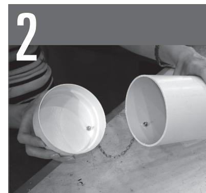
2 Adherir a cada uno de los extremos de cada caño una tapa de PVC estándar, del mismo diámetro, con una cadenita fina galvanizada, de 20 cm de largo, sujeta en sus extremos con tornillito con tuerca.
