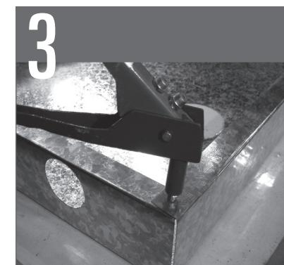
Armar los laterales de la caja utilizando remaches tipo "pop". Antes de sujetar el último extremo corto de 1 m. Colocar en el interior, la chapa lisa ya perforada.
