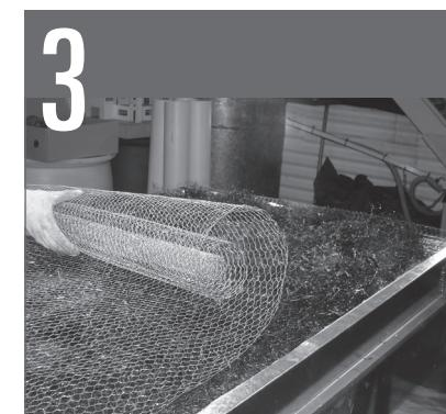
Doblar por encima de la viruta los 2 m<sup>2</sup> sobrantes de la malla de alambre y atar sus bordes con alambre, de modo que la viruta quede aprisionada.
