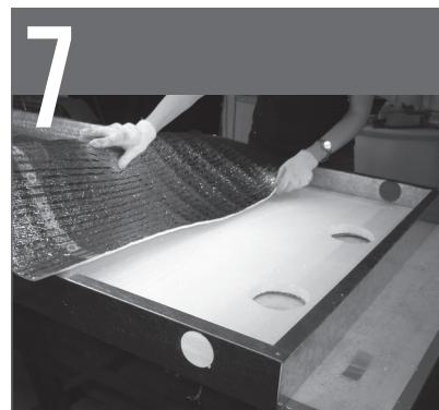
Recubrir toda la superficie interior usando algún aislante térmico fino con superficie aluminizada u otro material similar, del que se utiliza en la cocción de alimentos u otro material similar (lámina reflejante), la cual se pegará al telgopor con cola vinílica.
